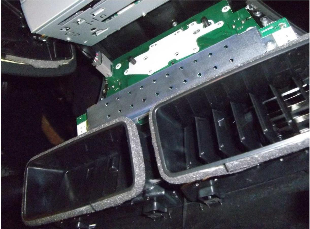
Und nun endlich die Blende zerlegt, da man ja einige Teile (Schrauben, Warnblink Schalter Lüftungsdüsen) weiterverwenden muss.
