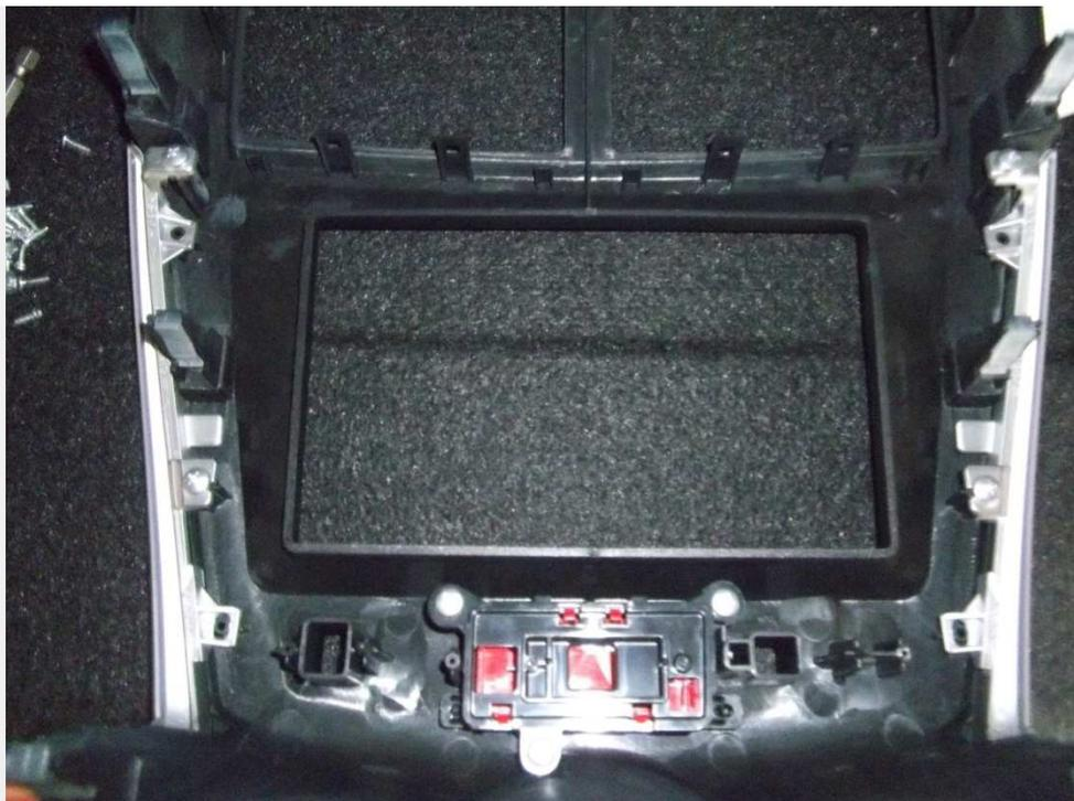
Neue Blende mit angebauten Zierleisten und Warnblinkschalter
