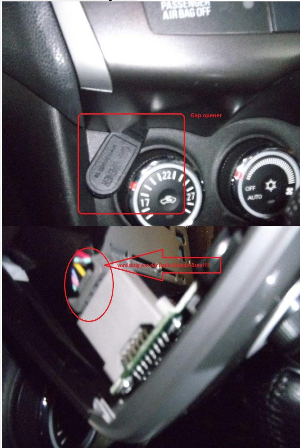
(mit Gap Opener die Blende gelöst und abgezogen, den Airback/Display Stecker gelöst und die Blende vorsichtig bei Seite gelegt , die 4 Schrauben gelöst und gut verwahrt und dann das Radio herausgezogen und die Kabel auf der Rückseite abgezogen), festgestellt, dass
