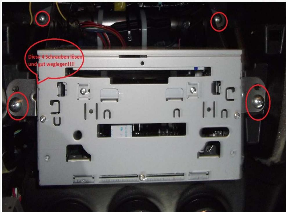
Also Stromversorgungsanschluss der Freisprechanlage ab, und Batterie nochmals dran, und siehe da Lautsprecher funktionieren auch so. Batterie wieder ab.....ausgebaut was nicht mehr nötig war und wo ich gut drangekommen bin. Die schwarze Box mit dem Relais fest
