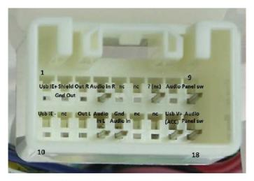
Die Anschlüsse 1,2,3,10,12,17 gehen auf die USB box (normales Radio ohne BT Freisprechen) oder den Hands Free ECU Adapter (mit BT)
